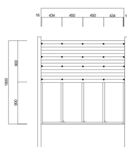
ボードをアルミ胴縁のトップに合わせてボードの凹部にドリルネジ(4x16)小頭のビスでビス止めして下さい。
