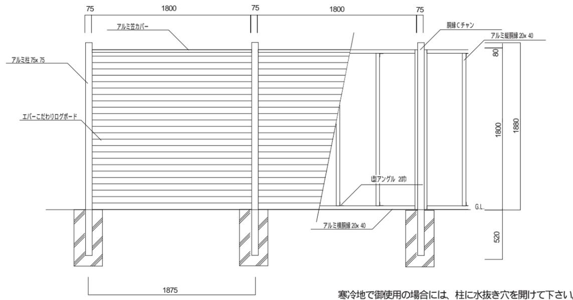
寒冷地で御使用の場合には、柱に水抜き穴を開けて下さい。
