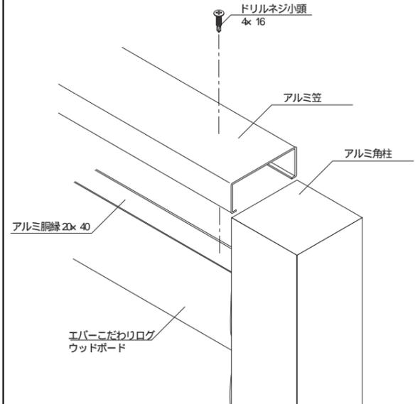
アルミ笠をアルミ胴縁とボードの上にはめ込み、ドリルネジ(4x16)小頭のビスでアルミ胴縁に固定して下さい。
