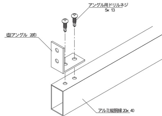
アルミ縦胴縁の両端にコーナーアンクルを仮穴に合わせてアンクル用ドリルネジ(5x13)で固定して下さい。
