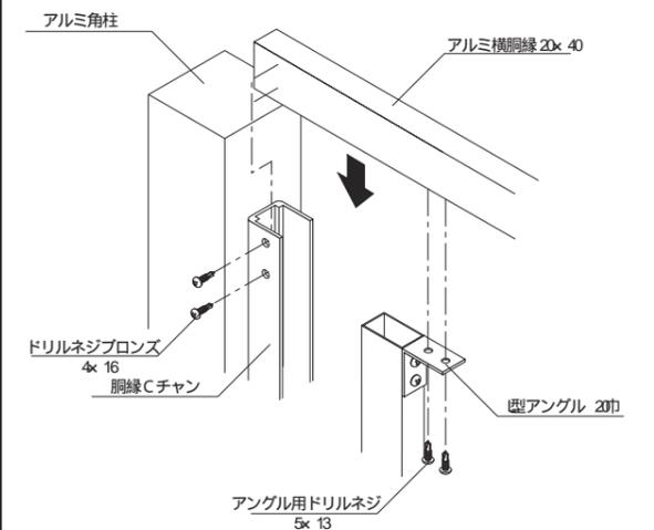
アルミ胴縁Cチャン付柱の上下にアルミ横胴縁をはめ込みドリルネジ(4x16)で固定します。アルミ横胴縁を取付た後、横胴縁の仮穴に合わせて、アンクル用ドリルネジ(5x13)で固定して下さい。
