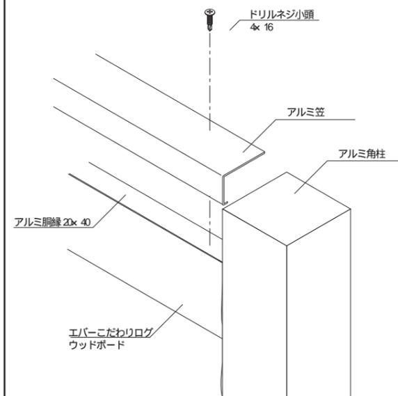
アルミ笠をアルミ胴縁とボードの上にはめ込み、ドリルネジ(4x16)小頭のビスでアルミ胴縁に固定して下さい。
