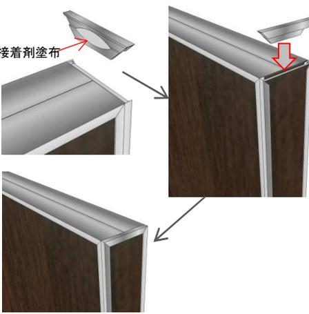
・上部見切材にフェンスセットで使用した接着剤の残りを使用し、柱に接着固定させます。スライドして差し込む際、上部の見切ロングに接着剤が付着しないようご注意ください。
