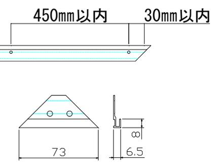
・見切材にφ5mmの仮穴を開けます。ビスの固定ピッチは中間 450mm以内、両端は30mm以内の位置というルールにしたがってL1800の見切材には5箇所 仮穴を開けてください。
