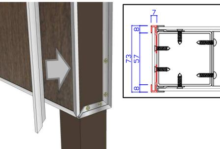
・ボードフェンス正面に使われている見切材の位置を参考に側面・下部と見切材を固定してください。
