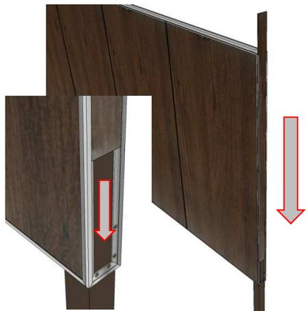
・側面用アートボードを上から差し込み、スライドさせて取り付けます。事前に見切を固定させるビスが飛び出してボードに緩衝しないか確認してください。無理にスライドさせると抜けなくなる恐れもありますので、差し込むスペースに障害物がないことを事前にご確認ください
